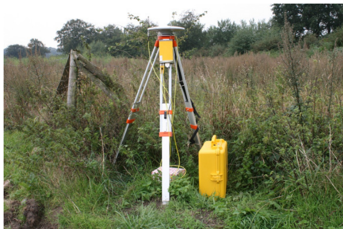
Abbildung 6.4: RTK-Referenzstation positioniert am Feldrand
