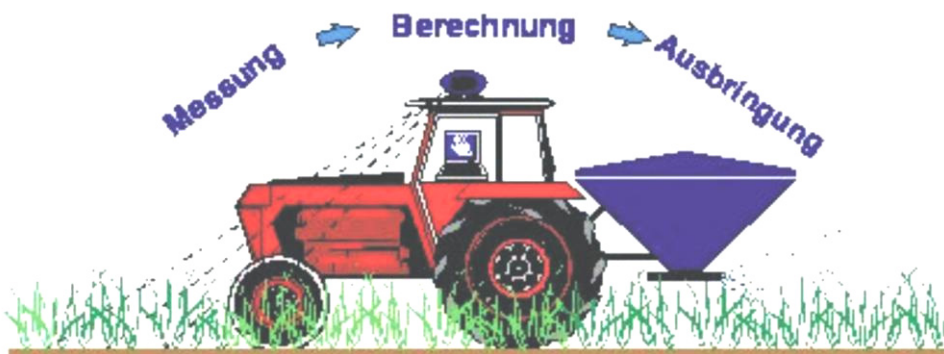
Abb. 3-1: Schematische Darstellung der Funktionsweise des Reflexionssensors Erfassung – Berechnung – Regelung der Ausbringungsmenge in Echtzeit (Yara, 2004, geändert)
