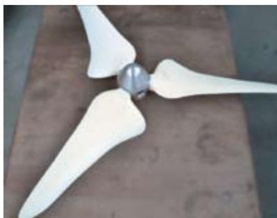
Eine im Labor für Numerische Mechanik entwickelte Rotorform für eine freilaufende, nicht ummantelte Kleinwasserkraftanlage
