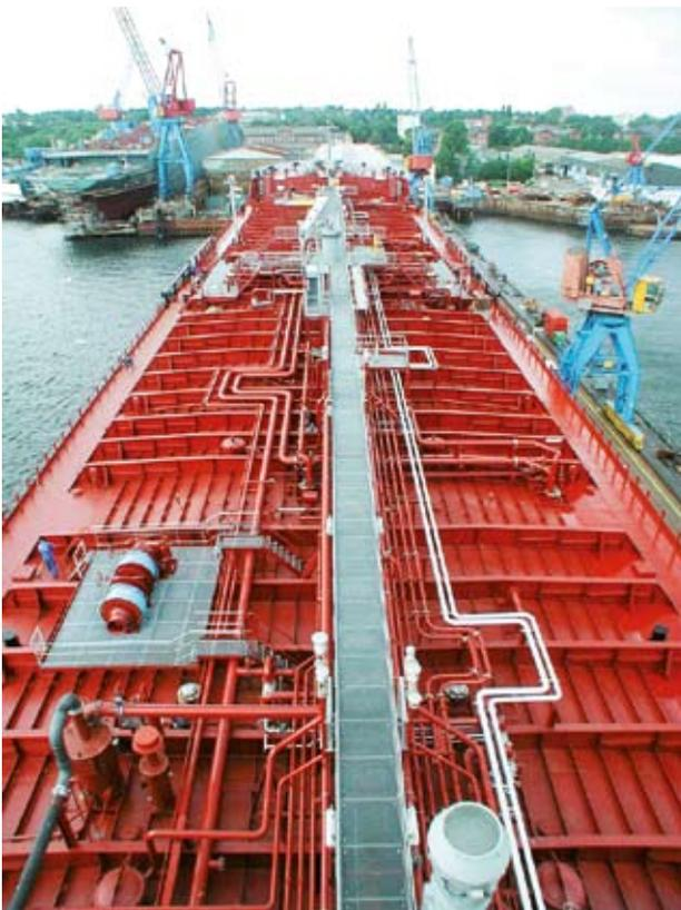
Rohrleitungssystem auf dem Deck eines Tankschiffs
