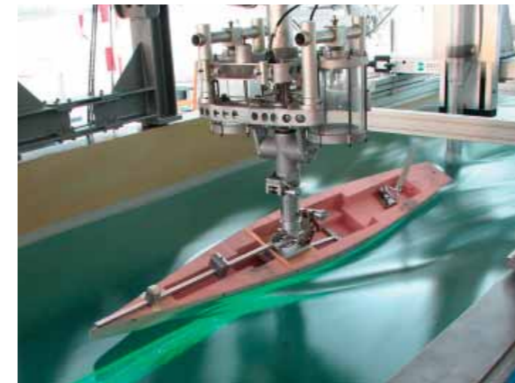
Schnelle Rennboote: Strömungsversuche in Versuchsaufbauten gehören zur Forschungsleistung in der Yacht Research Unit Kiel.
