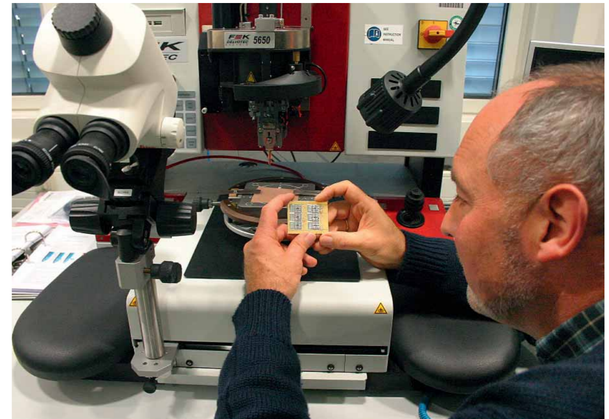
Bauteile effizienter und haltbarer machen: Dieses unverkleidete Leistungsmodul für eine Windkraftanlage entstand am Institut für Mechatronik (links). Durch neue Verfahren der Silber-Sintertechnik können Professor Ronald Eisele und sein Team die Dauerhaltbarkeit stark belasteter elektronischer Bauteile deutlich erhöhen. Fotos: Joachim Welding
