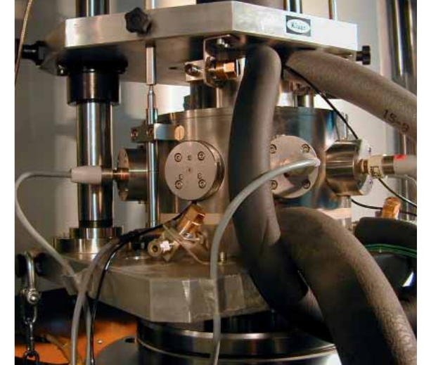
Hochdruck-Versuchszelle zur Durchführung eindimensionaler Verformungsversuche bei Temperaturänderung. Foto: Volker Feeser
