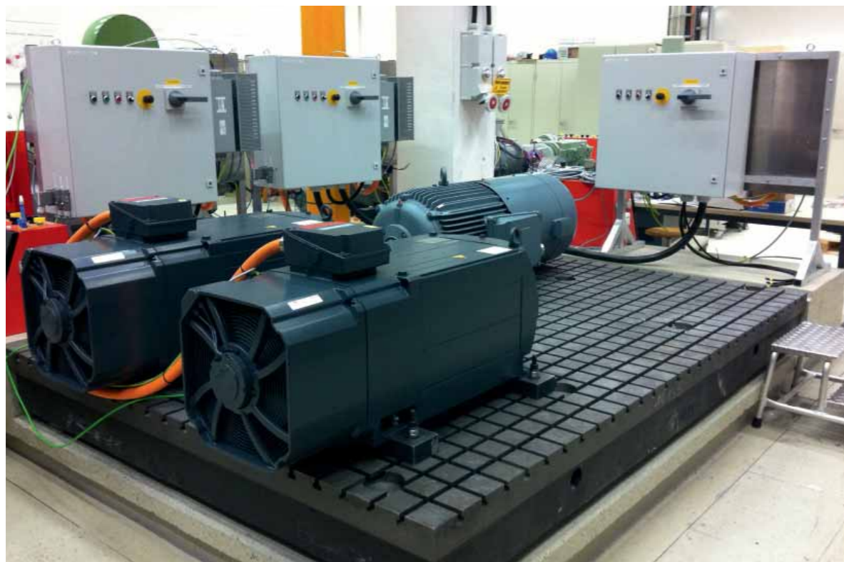
Neue Technologien: Prüfstand für das elektrische Modell einer Windkraftanlage.
