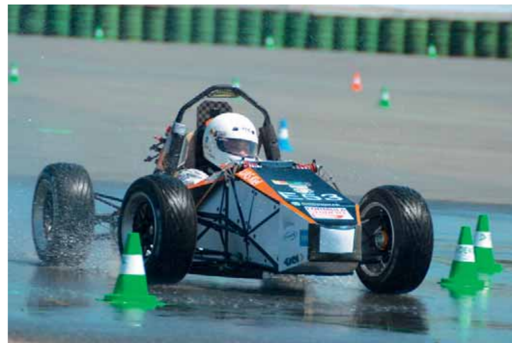
E-Mobilität rasant: Studierende der FH Kiel entwickelten 2013 diesen Elektro-Rennwagen für die »Formula Student«.
