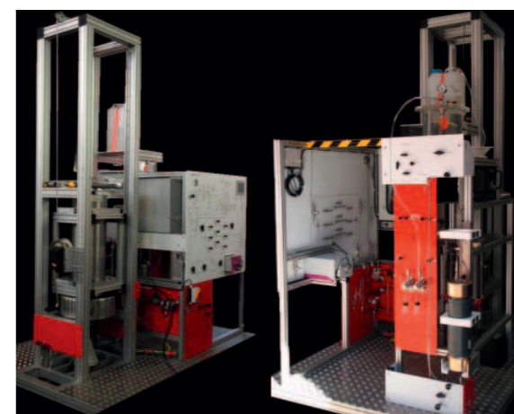
Technik für Energie: Zwei Versuchsstände für Drucklaborexperimente an Gashydraten sind an der FH Kiel entstanden.
