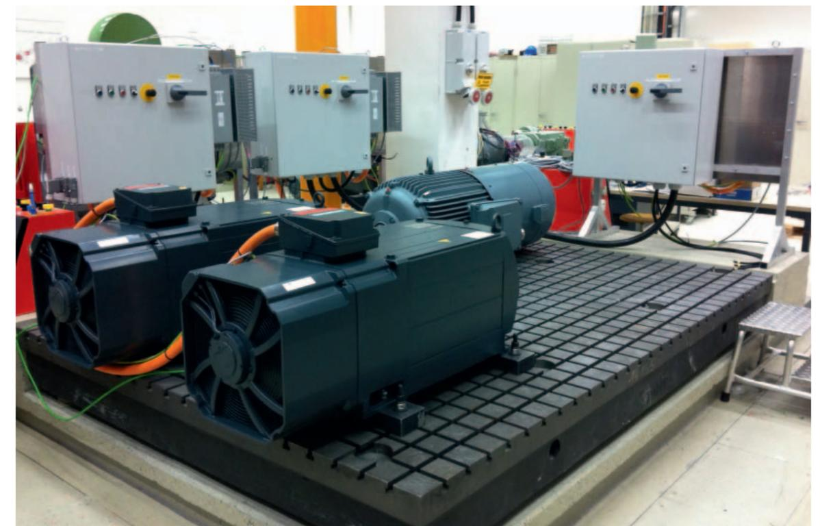
Neue Technologien: Prüfstand für das elektrische Modell einer Windkraftanlage.
